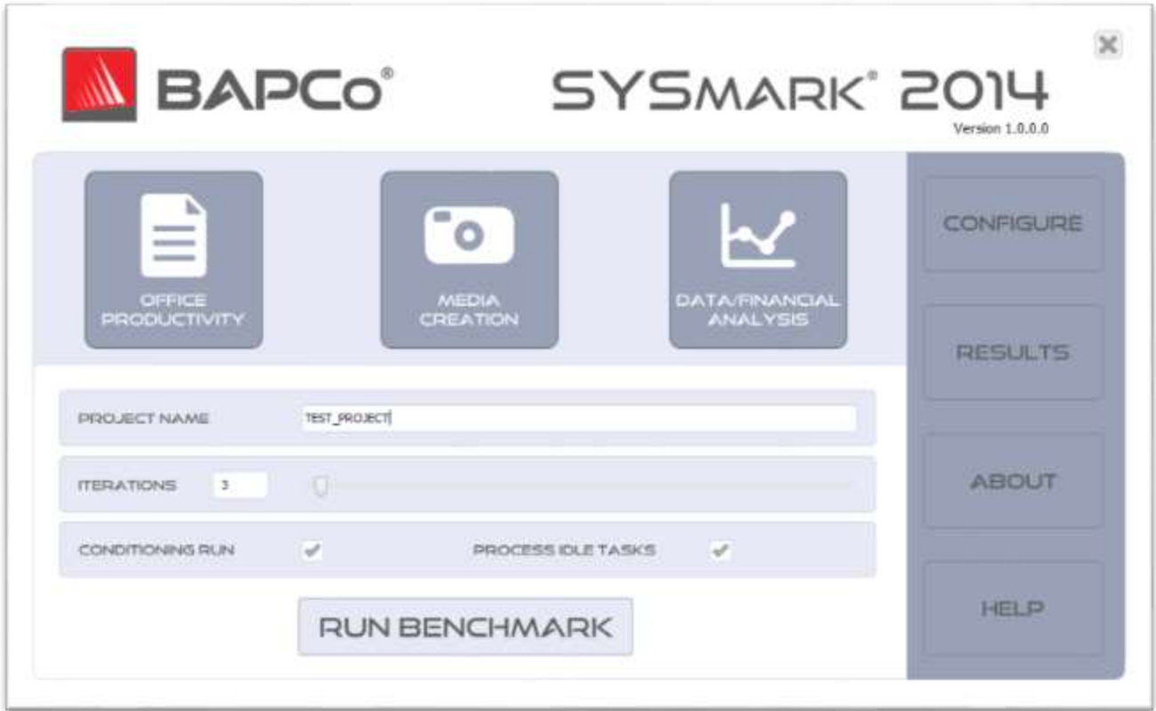
图 6: 显示着默认方案和迭代选项的 SYSMARK 2014 界面。请注意，默认情况下已选中调节式执行。
